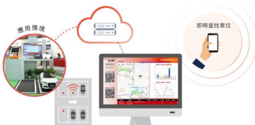
透過地磁偵測器結合NB-IoT網路服務，偵測戶外停車格位的占用狀況，除了能節省用路人找停車位的時間，也能減少道路擁塞及空汙排放。
