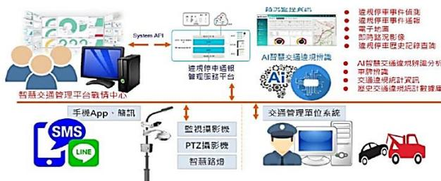
圖一、車輛紅線違停偵測應用服務解決方案架構
